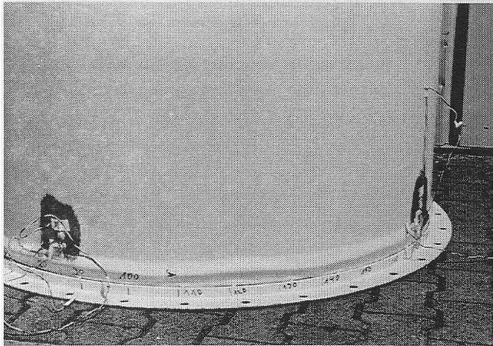
**Bild A.2:** Versuchskörper V13 (Serie A:  $R/T \approx 600$ ,  $\lambda \approx 1.0$ )
