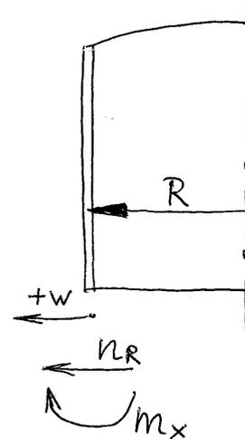
In einer einseitig halbunendlich langen Zylinderschale mit Symmetriebedingungen am betrachteten Rand benötigt man für eine Verschiebung der Schalenwand nach aussen um den Betrag  $w_0$  die radiale Streckenlast (z.B. Behälterskript Knödel - Z-Vertraeg)
