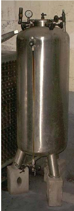
Bild 7: stehender zylindrischer Behälter, Edelstahl, 185 Liter
