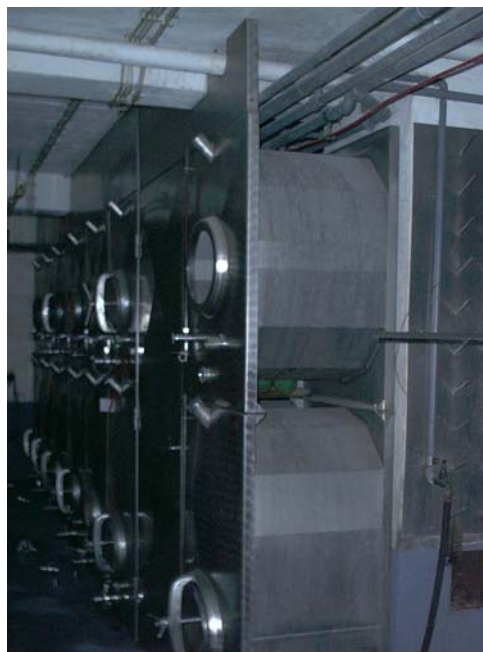
Bild 6: liegende, prismatisch-vieleckige Behäl- ter, Edelstahl, 385 Liter (oben), 630 Liter (unten)
