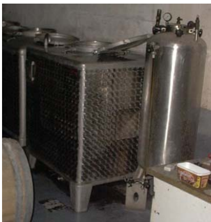
Bild 4: stehende eckige Edelstahl-Behälter je 1000 Liter
