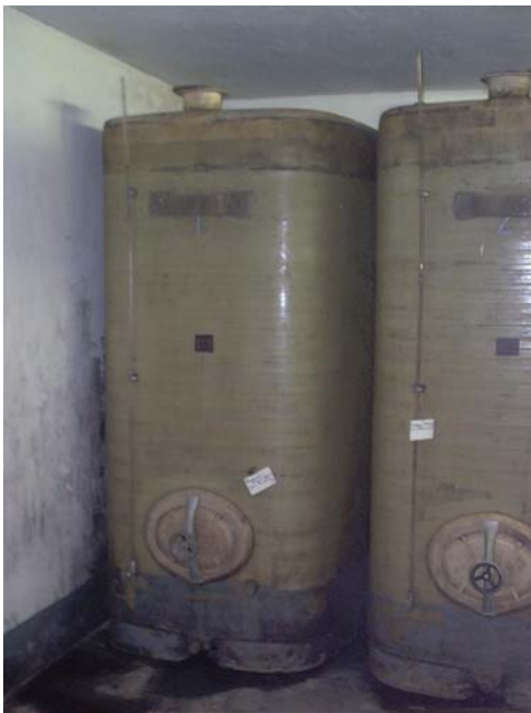
Bild 1: stehende GFK-Behälter, gewickelt, je 4800 Liter
