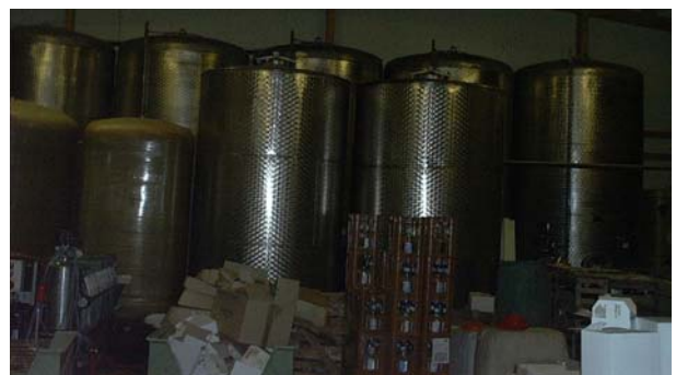
Bild 10: stehende zylindrische Behälter aus Edelstahl (9000 Liter), links im Vordergrund aus GFK (5000 Liter)
