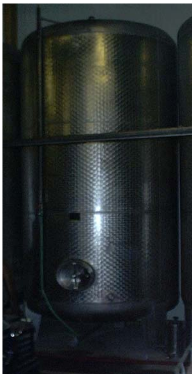
Bild 8: stehender zylindrischer Behälter, Edelstahl, 16900 Liter
