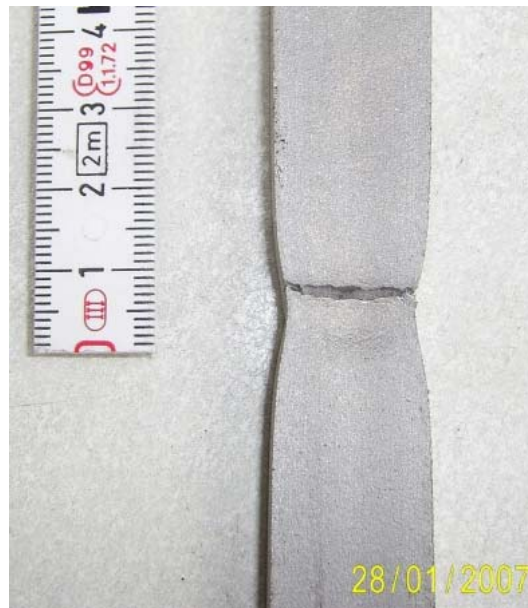
Flachzugprobe nach dem Versuch – FH Offenburg (Foto: P. Knödel)
